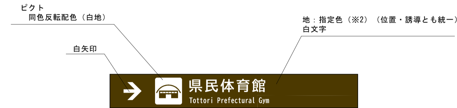
誘導サイン表示板
