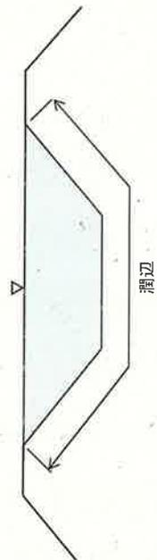
流れの断面のうち、空気と接する部分を除いた、水路の壁や底に接する部分の長さを潤辺という。
