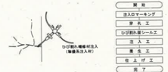
圧力調整注入工詳細図 (参考)
