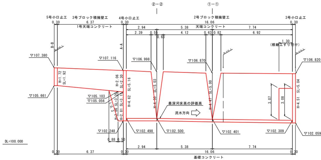
ブロック積擁壁展開図 (A箇所・B箇所) 一般部 S=1:50
