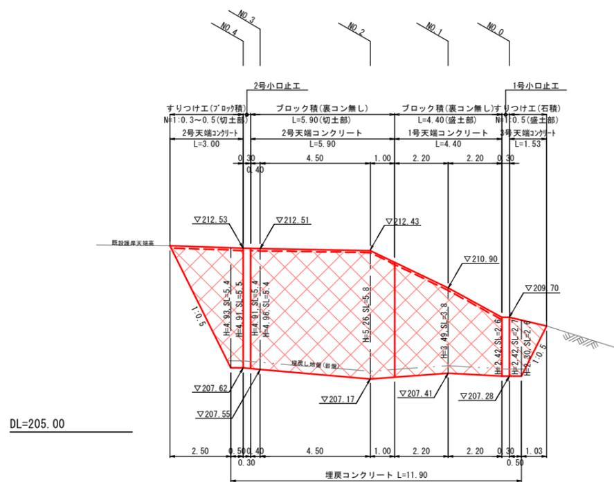
流路護岸工標準断面図(左岸側)
