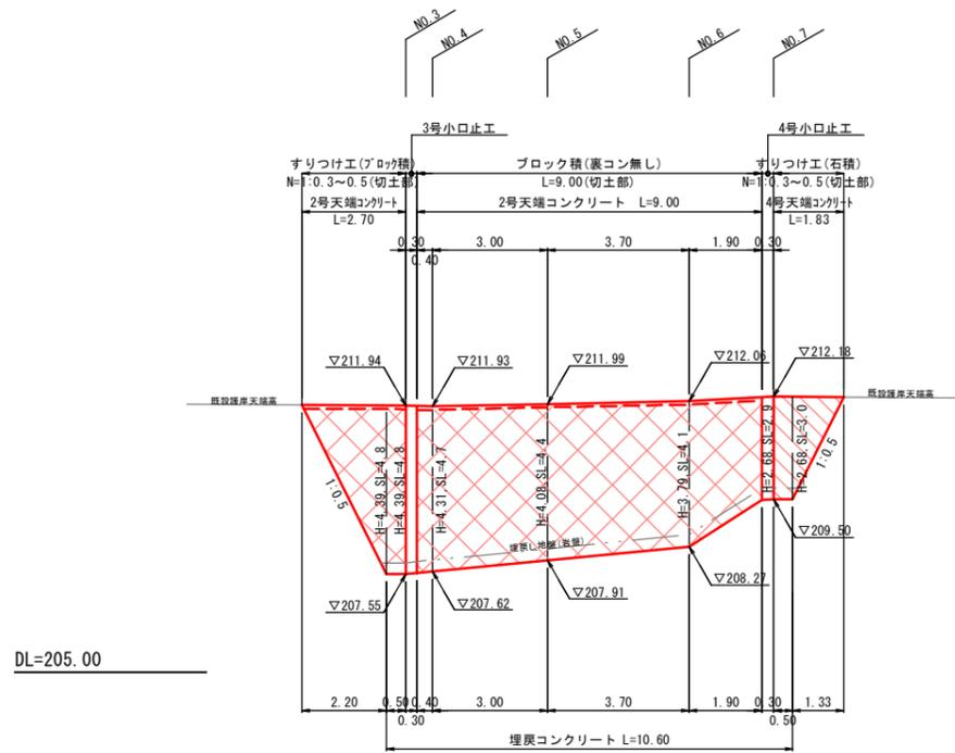
流路護岸工標準断面図(右岸側)
