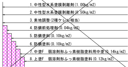
塗装塗替工(参考) (錆転換型防食塗装)
