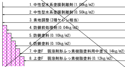
塗装塗替工(参考) (錆転換型防食塗装)
