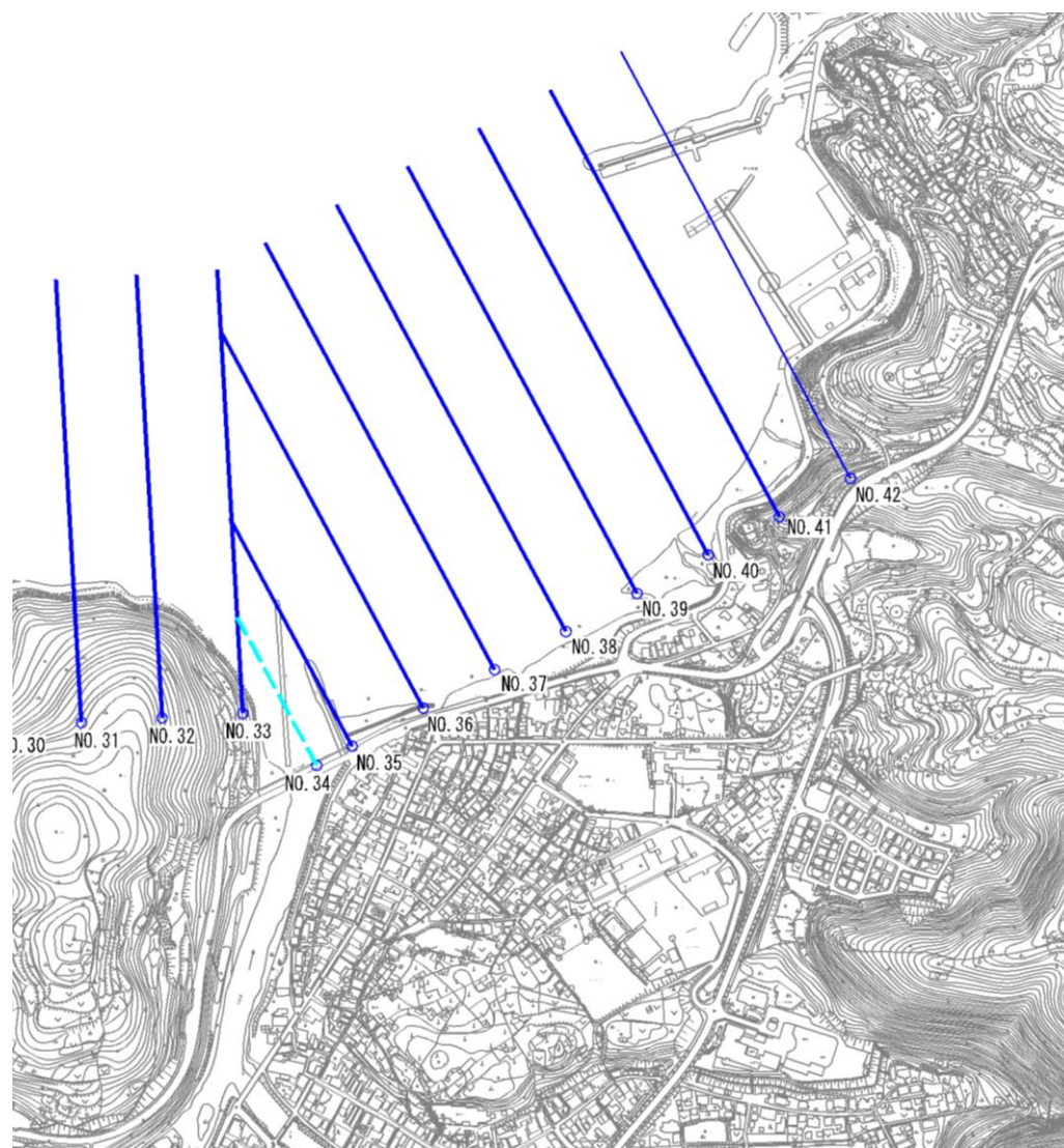
図 3.2.11 青谷海岸 深淺測量 測線平面図
