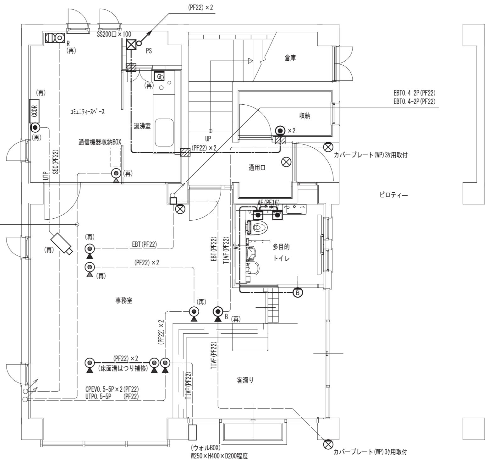
電話配管・情報通信・インターホン・TV受信・監視カメラ設備 1階改修図 (改修後) S=1:60
