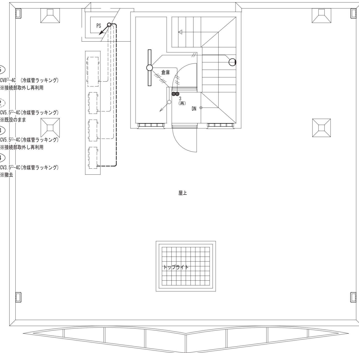
動力・電灯コンセント設備 3階撤去図（改修前）S=1:60
