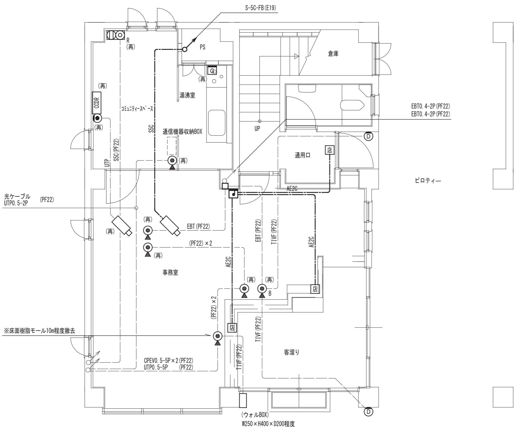
電話配管・情報通信・インターホン・TV受信・監視カメラ設備 1階撤去図 (改修前) S=1:60
