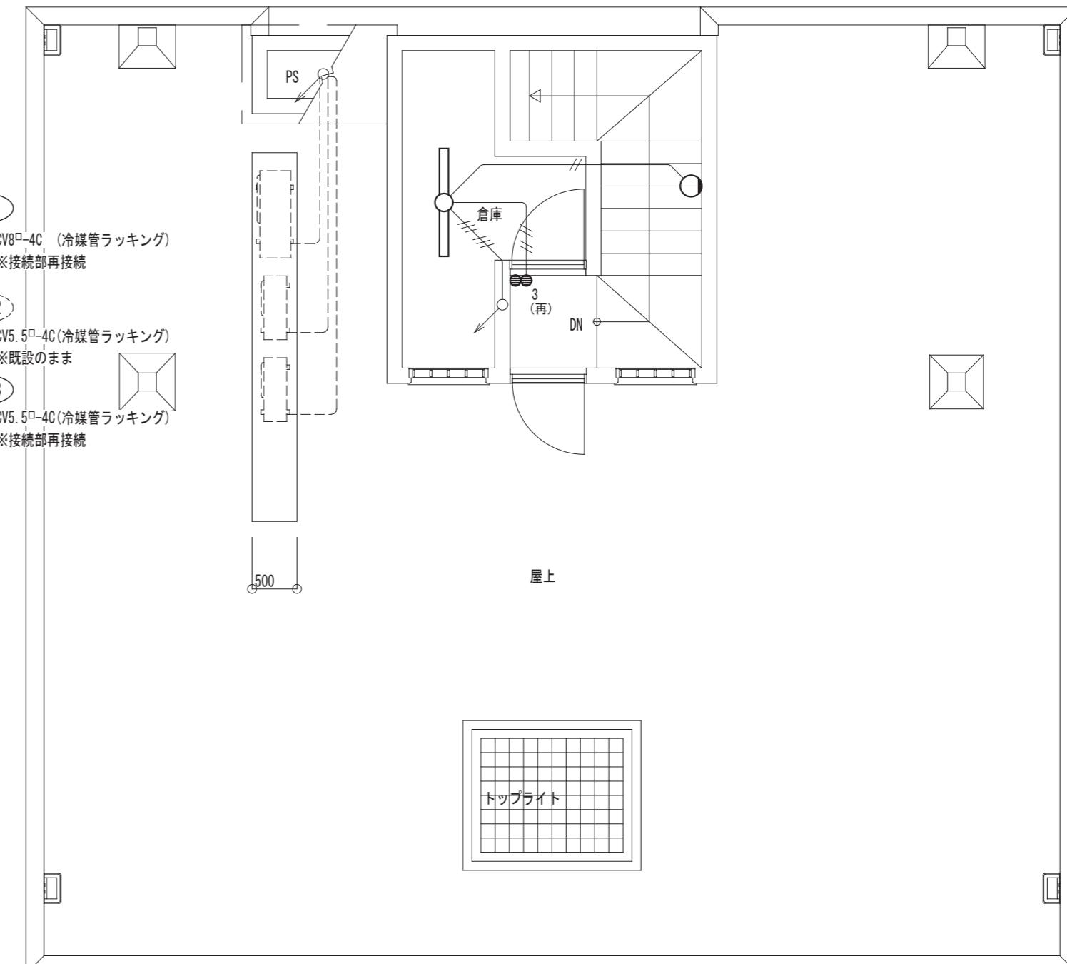
動力・電灯コンセント設備 3階改修図（改修後）S=1:60
