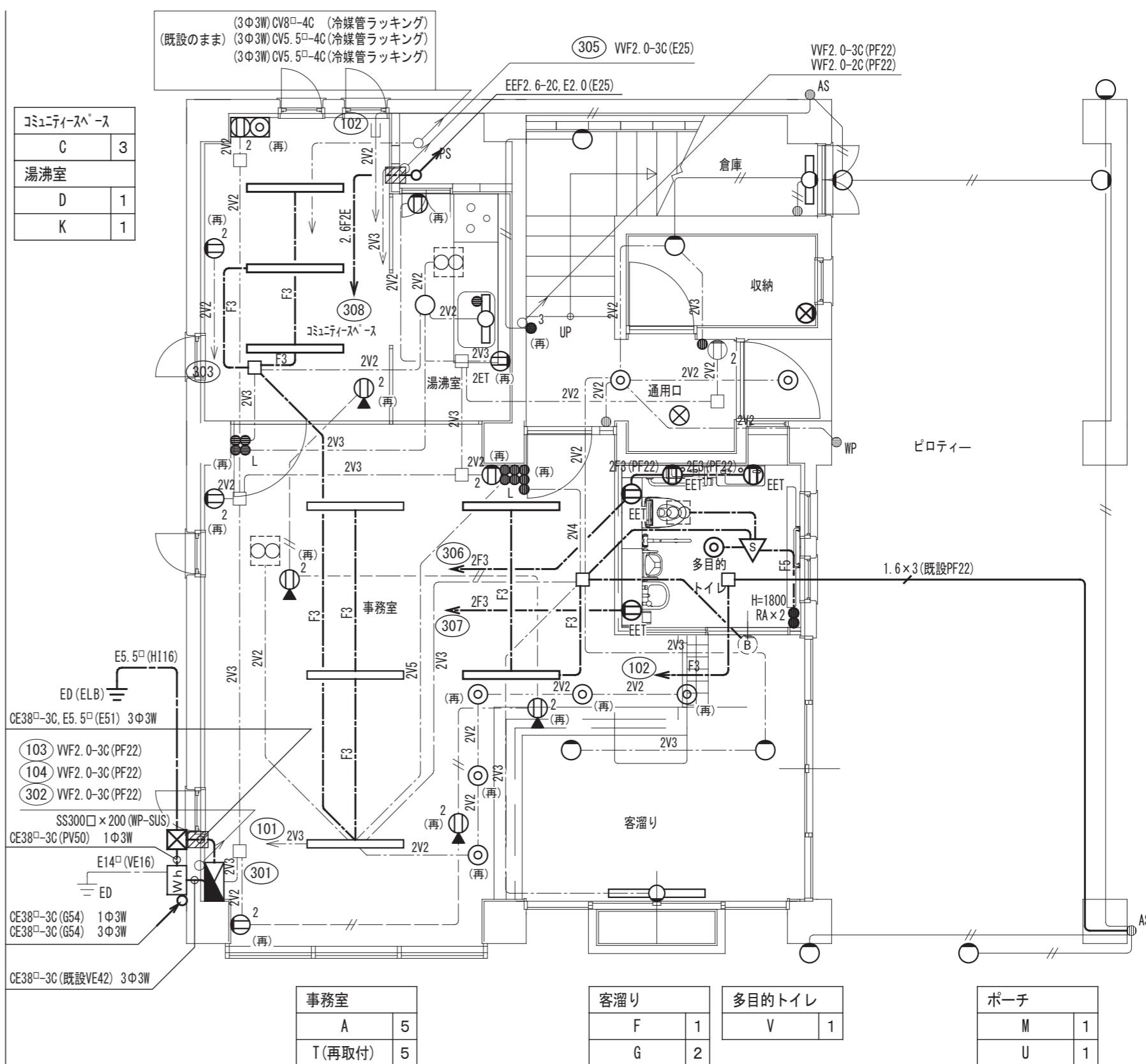
幹線・動力・電灯コンセント設備 1階改修図（改修後）S=1:60
