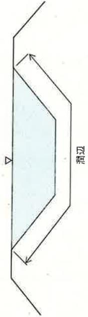
流れの断面のうち、空気と接する部分を除いた、水路の壁や底に接する部分の長さを溝辺という。本計算においては、満水を想定する。
