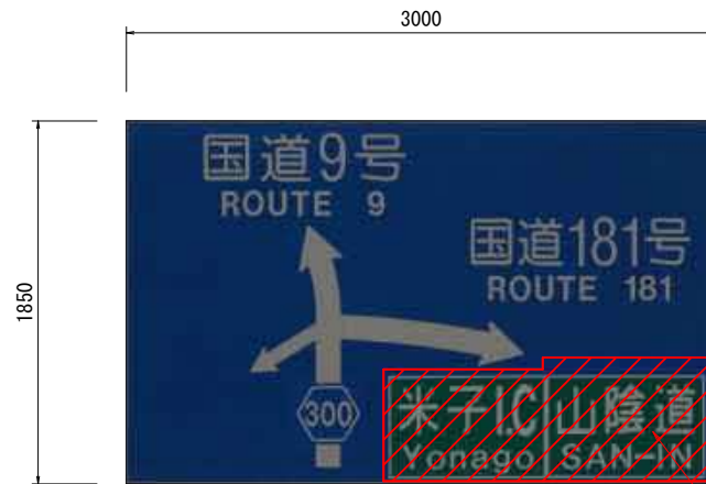
既設標識板詳細図 S=1:30
