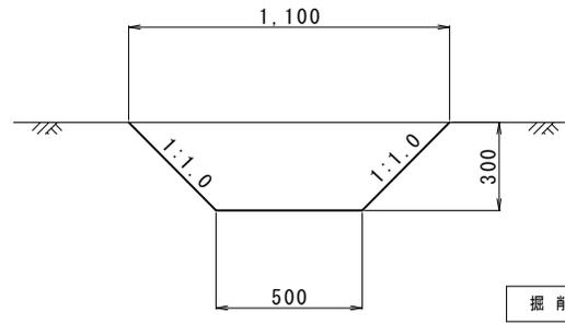
沈砂地 断面図
