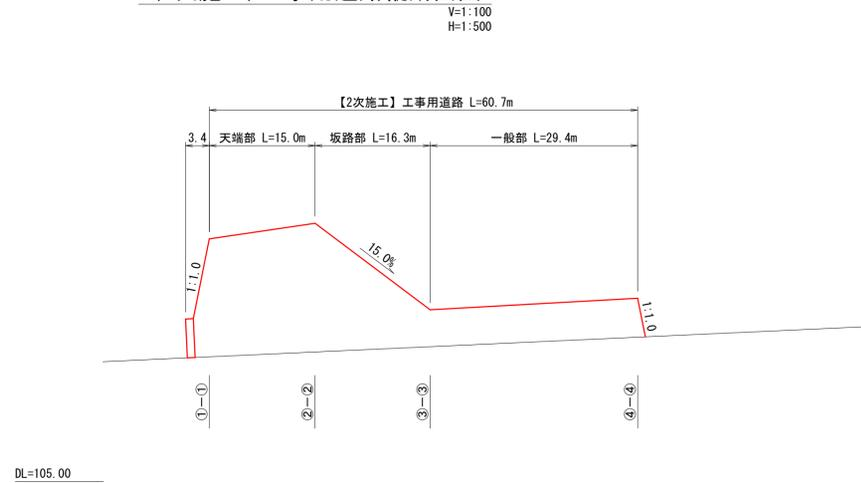
(2次施工) 左岸工事用道路縦断面図
