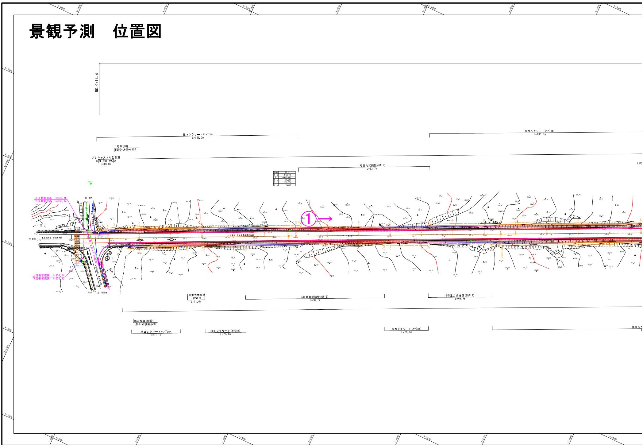
設計延長 L=905.8m 道路幅員W=5.50m(7.00)m 冬期幅員W=5.50m(6.50)m
