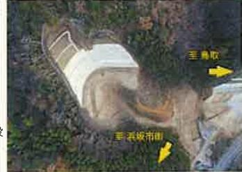
居組地区では、居組ICを入って左手側に居組トンネルを建設予定であり、その前準備として全12段の切土を計画しています。令和2年11月から現場着手し、令和3年末で上から6段目まで完成しました。現在はさらに2段を切土するよう工事をしています。
