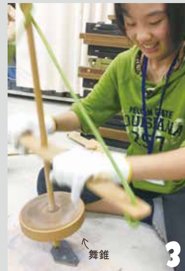
3 ひもを通す孔を舞錐であけます。素材が厚いほどに作業は難航。2時間かかる部員も。
