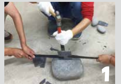
1 粘板岩をノミで打ち、割板状の素材とります。思い切りが大事！
