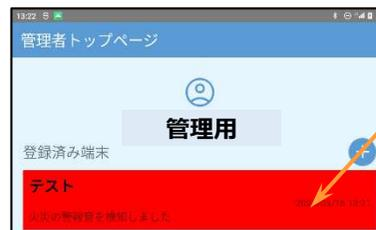
1. エレベーター内タブレットが警報音を認識すると赤く表示し、エレベーター内タブレットが緊急時モードに切り替わったことを示します。
