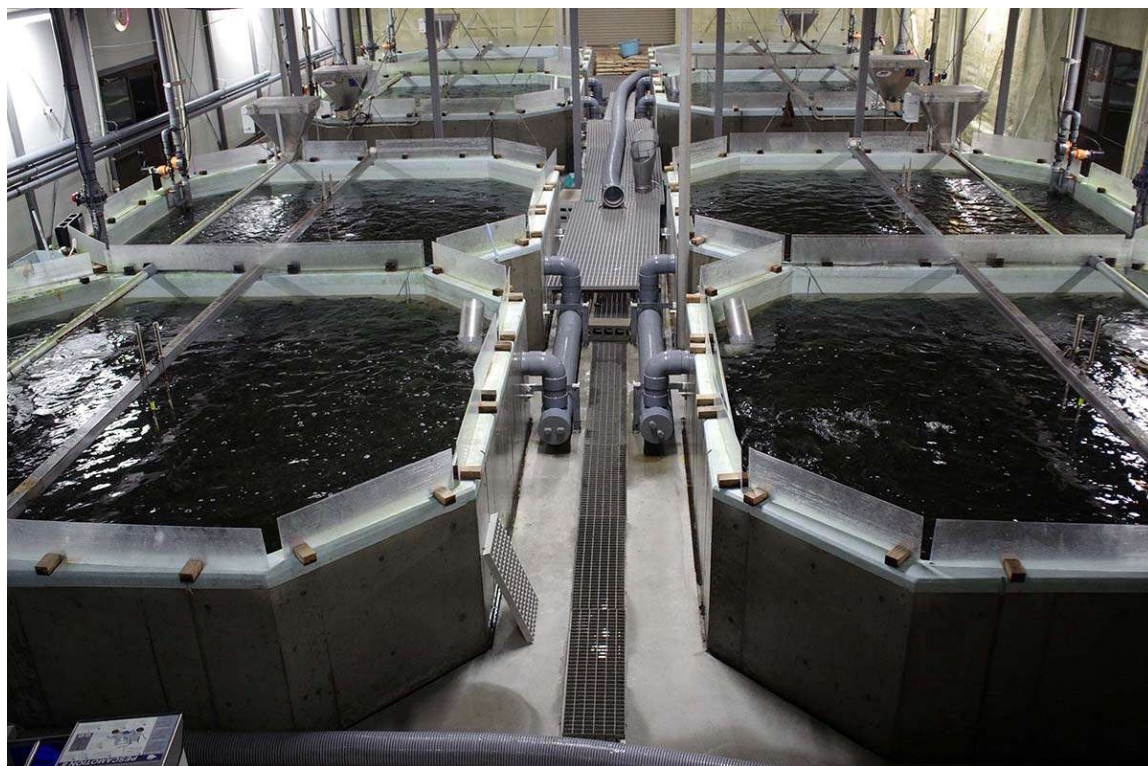
最先端の陸上循環濾過養殖プラント(RAS)の様子
