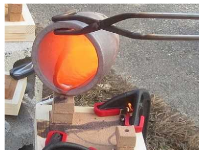
鑄込み （とがした金属を砂型に流し込む）
