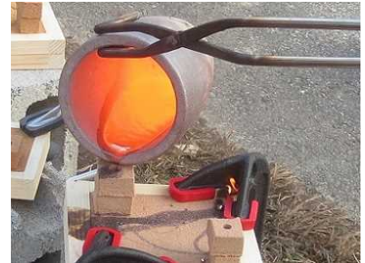
鋳込みの様子 (とがした金属を砂型に流し込む)
