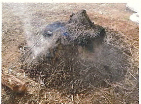
8. 火が消えて、温度が下がるのを待ちます。約24時間後に取り出します。
