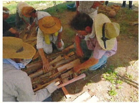
2. 窯を作る場所の土を5cm程度削り、底に土器片を敷詰め、燃料になる薪を3段程度積みます。
