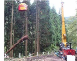
簡便に架線集材できる人工支柱を装備した移動可能な集材機
