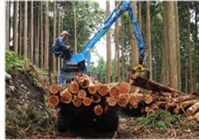
原木丸太をグラップルクレーンで荷台に積んで運ぶ集材専用の自走式機械
