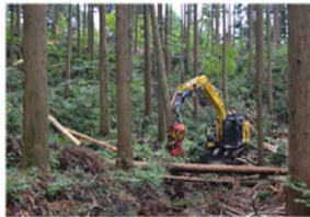
立木の伐倒、枝払い、玉切りと材の集積作業を連続して行う自走式機械
