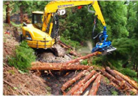
立木の枝払い、測尺、玉切りを林道や土場で連続して行う自走式機械
