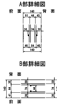
①コネクティブストリップ (S=1:10) ②ジベル筋 (φ6丸鋼(メッキ)+φ19PP) ③吊り金具 (1-1.3 t用)
