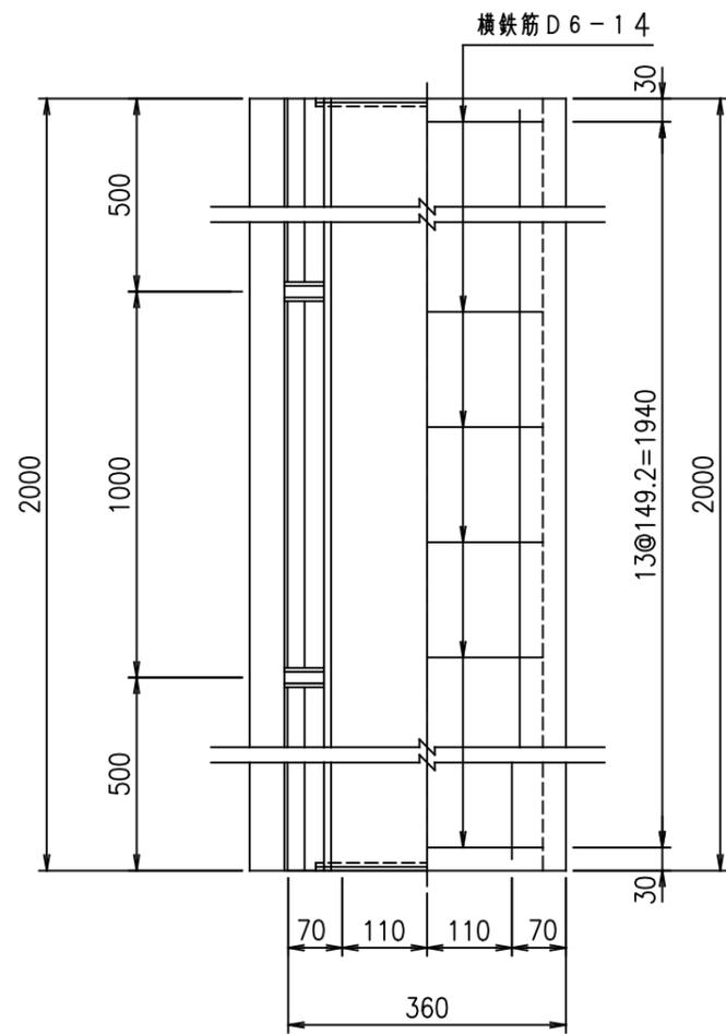
吊り用インサート詳細図 S = 1 / 2
