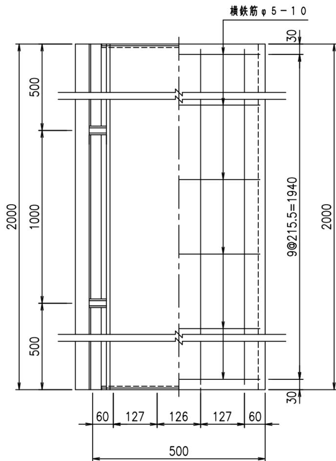
吊り用インサート詳細図 S = 1 / 2
